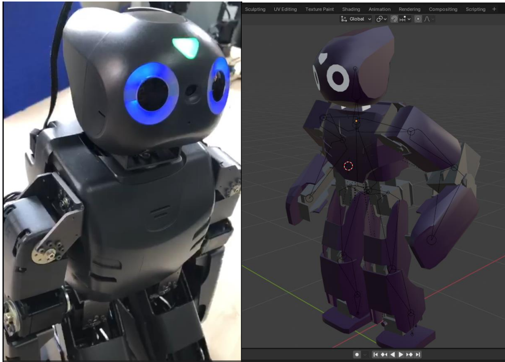
Figura 21. Robot Darwin OP Vs Gemelo Digital Fuente: USTA, autor.
