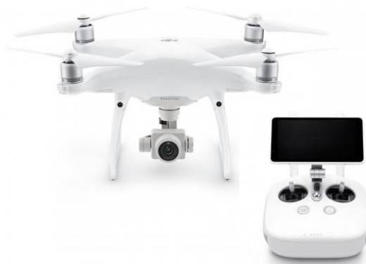
Figura 46. Equipo UAS (Phantom 4) utilizado en la misión levantamiento topográfico y fotogramétrico construcción nueva Clínica de Giron E.S.E.
