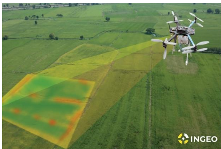
Figura 1. Levantamiento de nuestras fotogramétricas para topografía con drones
