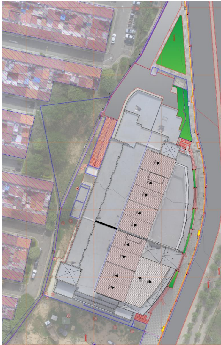
Figura 49. Ejemplo de detalles físicos de zonas verdes, vías, cubierta de edificación y del urbanismo identificados en el Ortomosaico escalado y la fotointerpretación.
