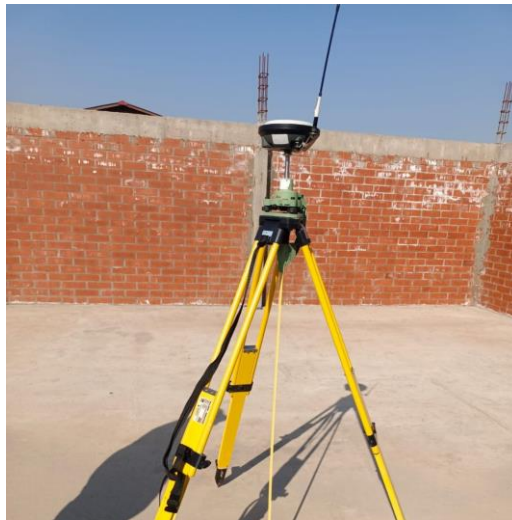
Figura 29. Sistema GNSS de alta precisión con antena para ubicación puntos de control
