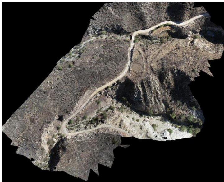
Figura 10. Ortomosaico y nube de puntos en posproducción con Propeller (Caso 1)
