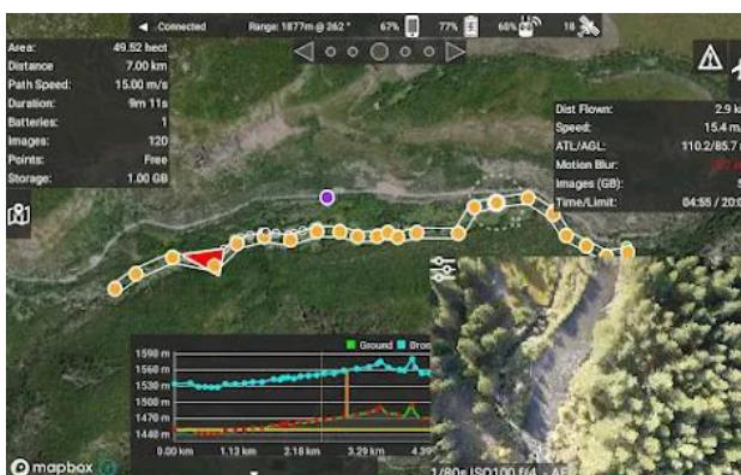
Figura 8. Programación de Vuelo en MAP PILOT y solape (Caso 1)
