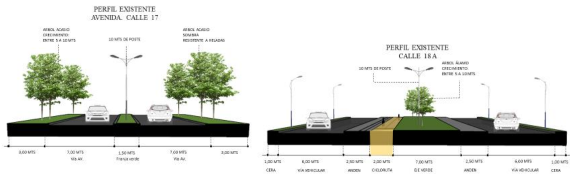
Grafica 28. Diseño Perfiles existentes, determinantes urbanas.
