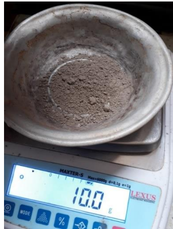
Figura 16. Masa del llenante mineral para su densidad bulk
