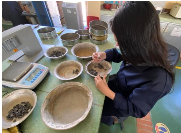
Figura 13. Inspección visual de caras fracturadas del agregado grueso
