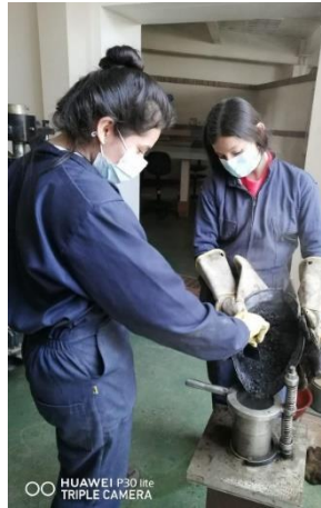
Figura 21. Mezcla asfáltica llevada al molde del pedestal
