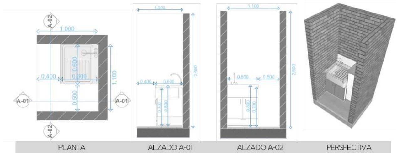
Figura 7. Descripción del área que debe tener la zona de ropas incluyendo medidas del mobiliario que tiene adicional al que ofrece la cartilla 1.
