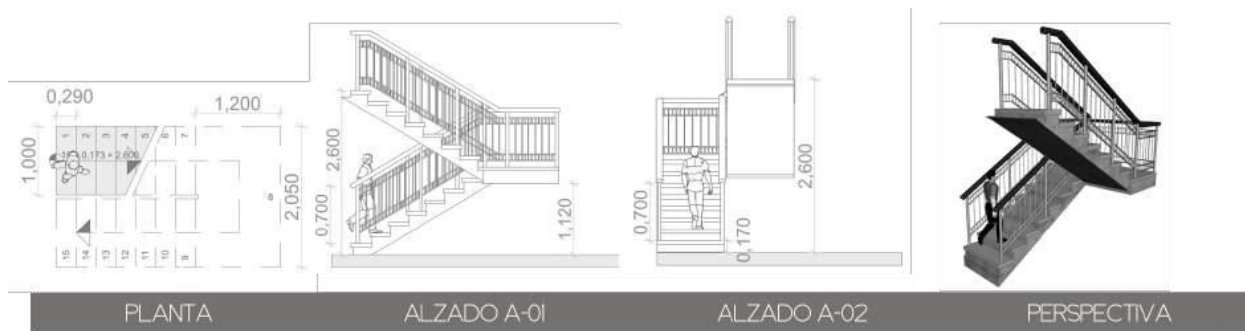
Figura 40. Áreas en metros de los componentes de la escalera dando prioridad a las personas de talla baja.
