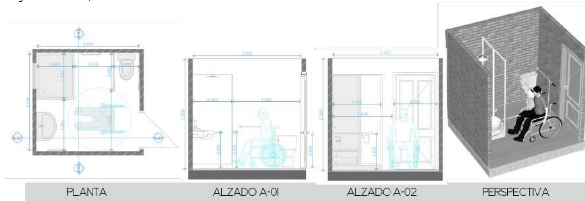
Figura 29. Espacio de un baño para vivienda de interés social donde se suplen las necesidades de todas las personas, mostrando las medidas del mobiliario incluyendo a esta accesibilidad.
