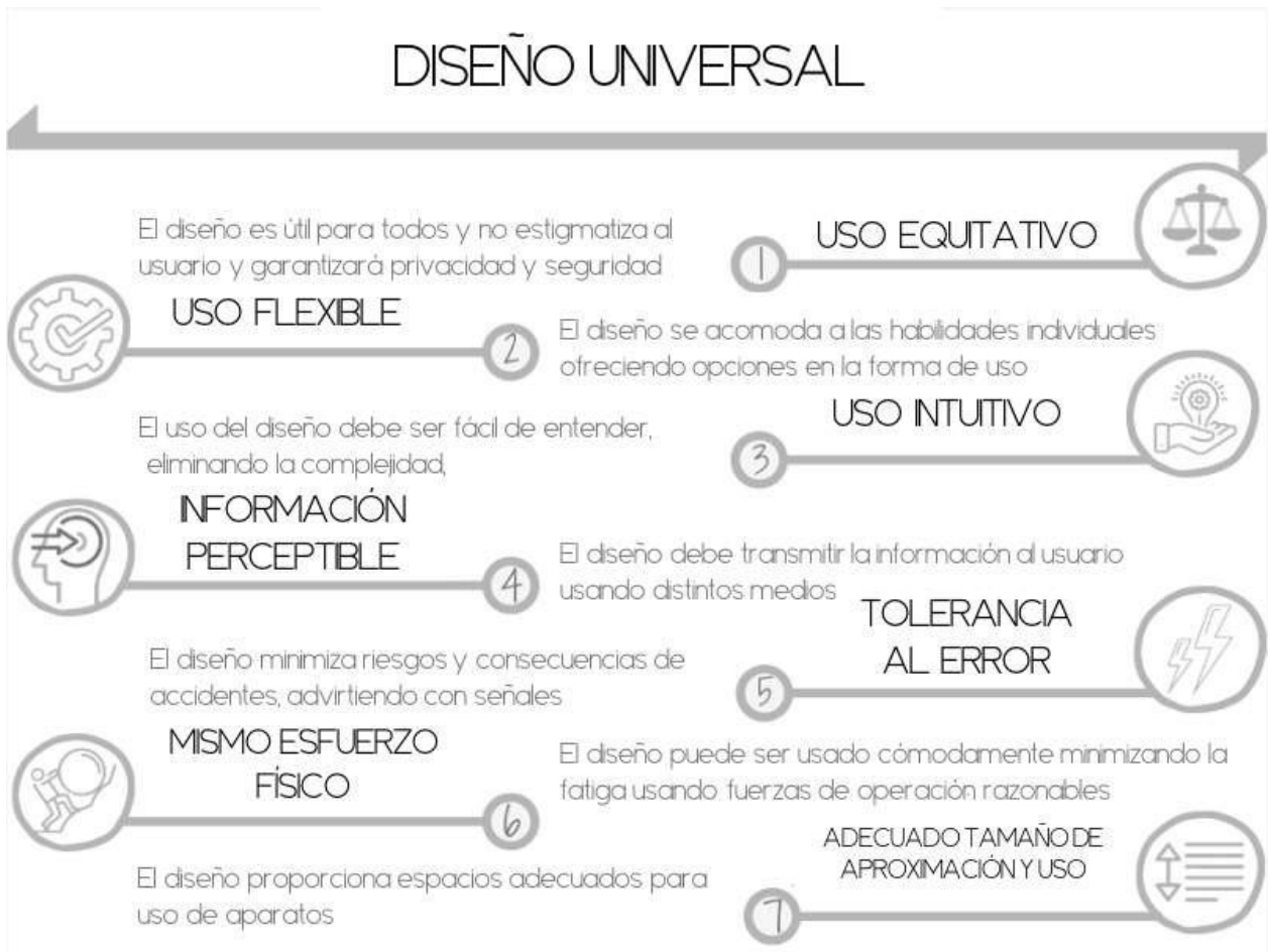
Figura 2. Parámetros del diseño universal, necesarios para la realización de una vivienda de fácil acceso y uso; estos parámetros nos permiten interactuar con el medio y con las personas de forma parcial de manera que supla las necesidades de toda persona.
