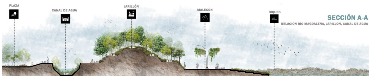
Imagen 20: Corte Jarillón, sección A-A. Elaboración propia.
