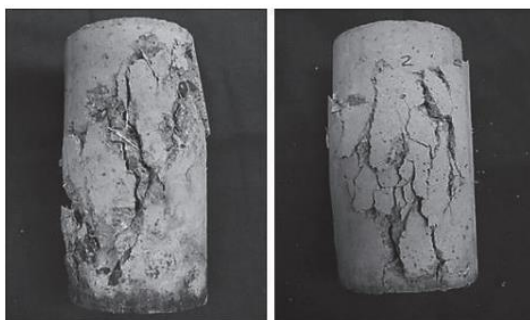
Ilustración 3 Modo de falla de concretos fibrorreforzados
