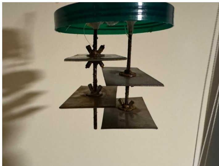
Fotografía 3: Distanciamiento de los ánodos y cátodos.
