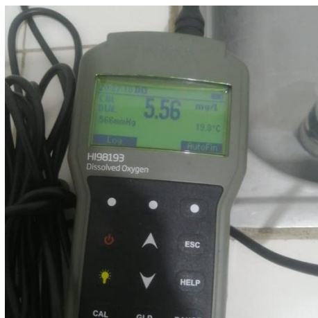
Figura 11. Medición Oxígeno disuelto con medidor portátil HI 98190. Fuente: Autora
