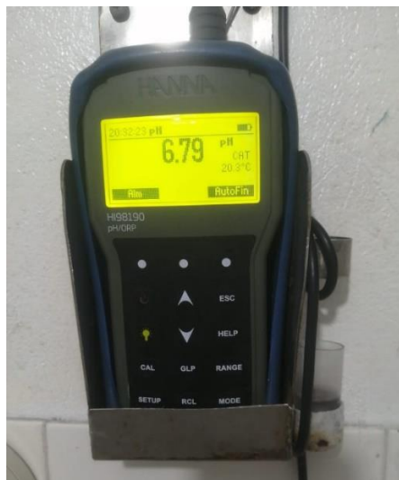
Figura 10. Medición pH con medidor portátil HI 98190. Fuente: Autora
