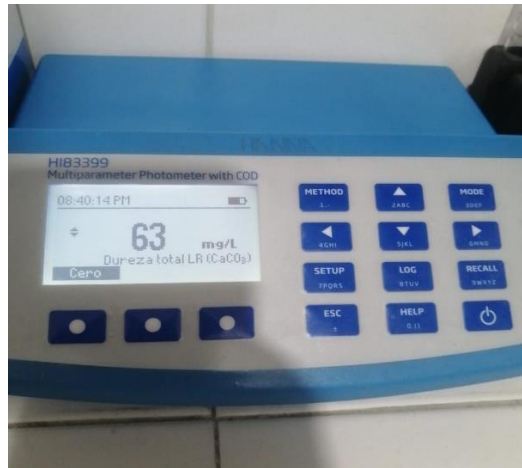
Figura 9. Medición dureza con fotómetro multiparámetro HI 83399. Fuente: Autora
