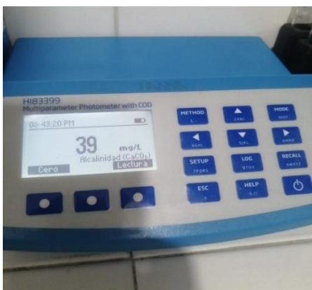
Figura 8. Medición alcalinidad con fotómetro multiparámetro HI 83399. Fuente: Autora
