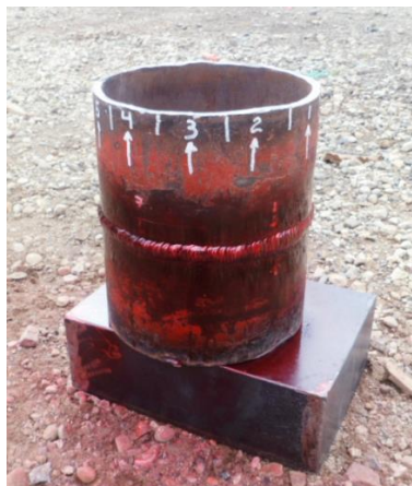
Ilustración 14 Tiempo de espera del penetrante
