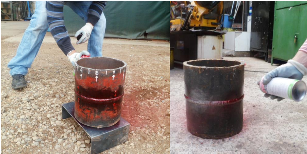
Ilustración 13 Aplicación del penetrante
