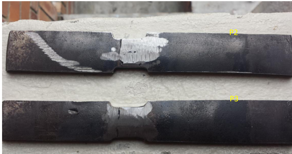
Ilustración 63 Probetas con defectos
