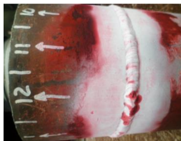
Ilustración 18 Líquidos Penetrantes toma 1
