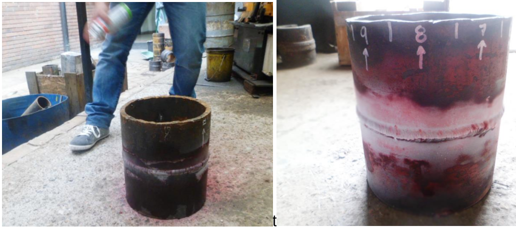
Ilustración 17 Aplicación de revelador
