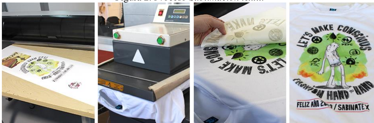
Figura 2: Proceso Sublimación textil.
