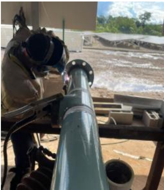
Figura 15. Soldadura de tubería con técnica GTAW.
