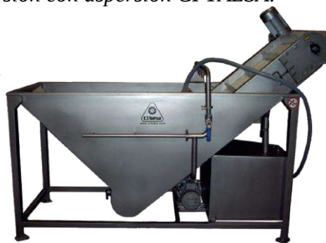
Figura 19. Lavadora de inmersión con aspersión CI TALSA.
