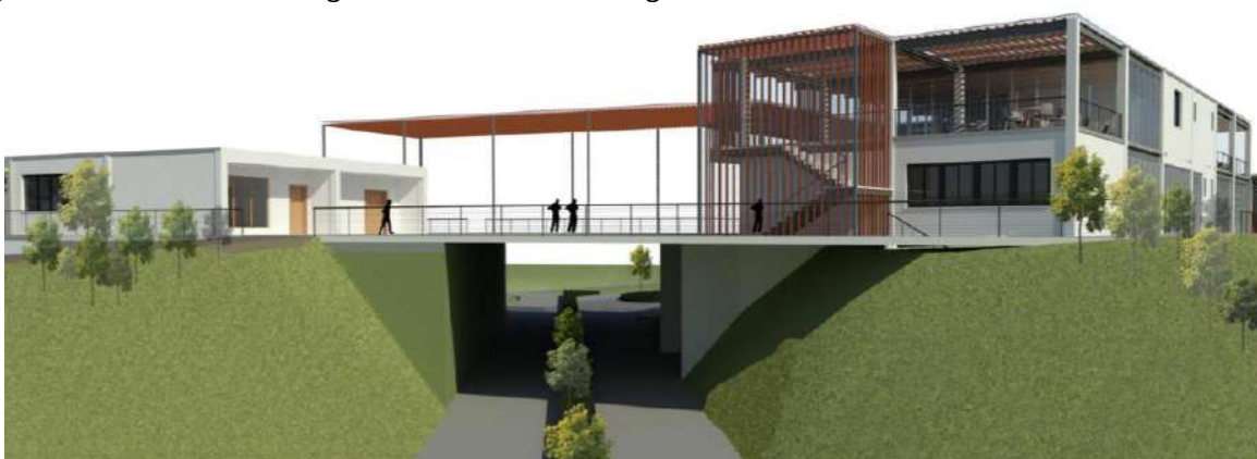
Figura 2. Paso desnivel ingreso a área de descargas.
