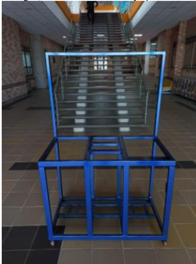
Figura 31 Ensamble de vigas, instalación de ruedas y aplicación de la pintura, barniz
