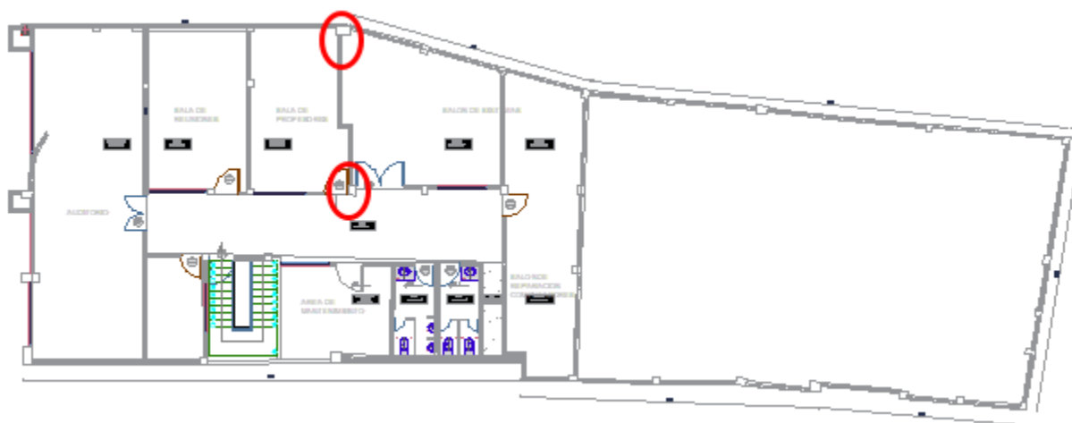
Ilustración 44. Esclerometría columnas nivel tres
