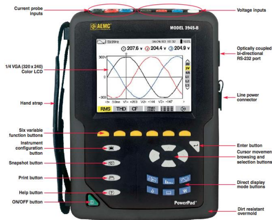
Figura 12. Analizador de calidad de potencia. Power Pad 3945-B, Controles del equipo.
