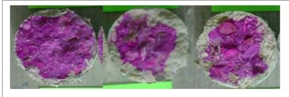
Figura 12. Probeta de ensayo con recubrimiento de buena calidad, w/c=0.8 y después de 23 días de exposición acelerada. El color morado indica el área libre de carbonatación. Tomado de Moreno, Solís-Carcaño, & Arias-Palma, 2008.
