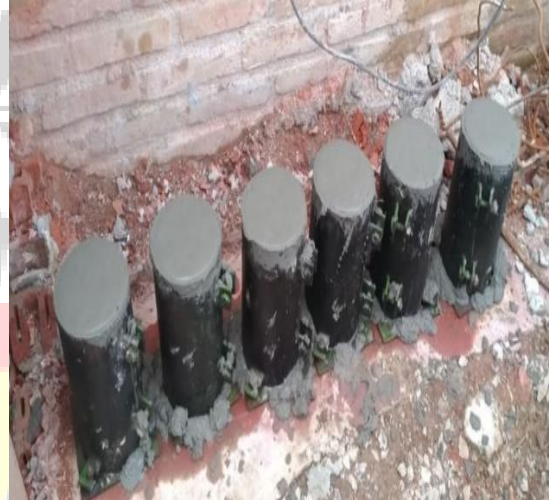
Imagen 36. Cilindros pilotes contratista
