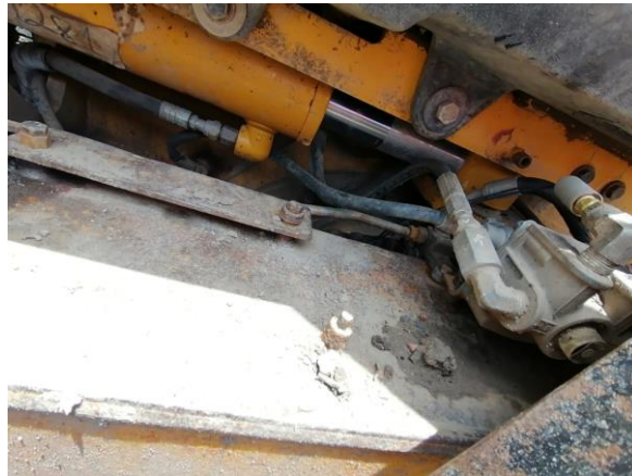
Figura 16 Cilindro de articulación central – Motoniveladora 1
