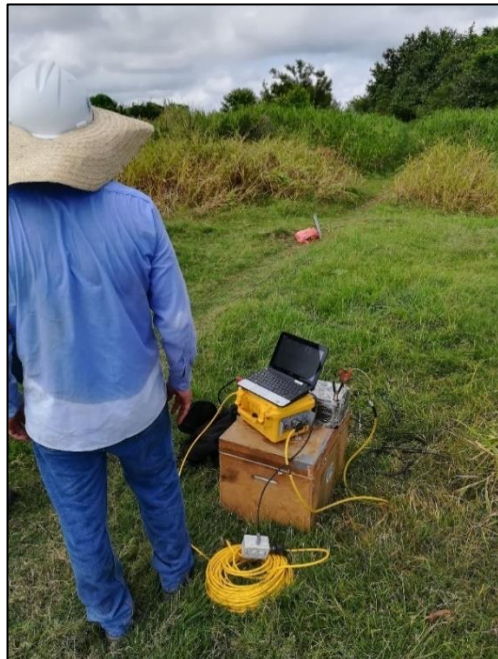
Fotografía 8 Realización de refracción sísmica
