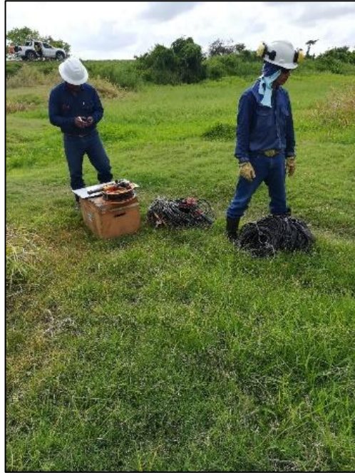
Fotografía 8 Realización de refracción sísmica
