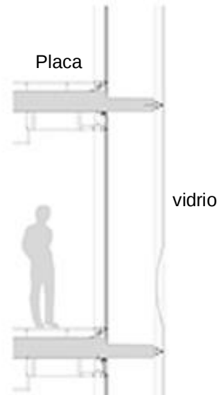
Detalle muro flotante
