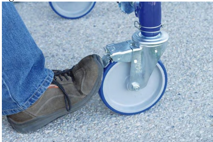
Figura 12. Aseguramiento base andamio
