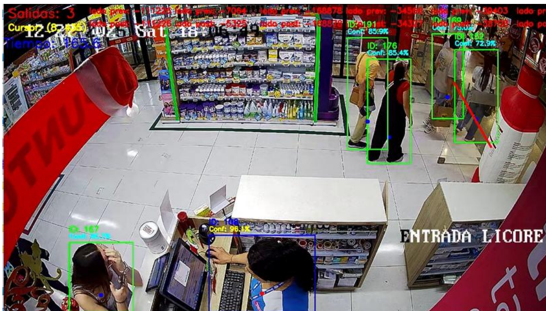
Figura 4. Detección de personas para medición de flujo
