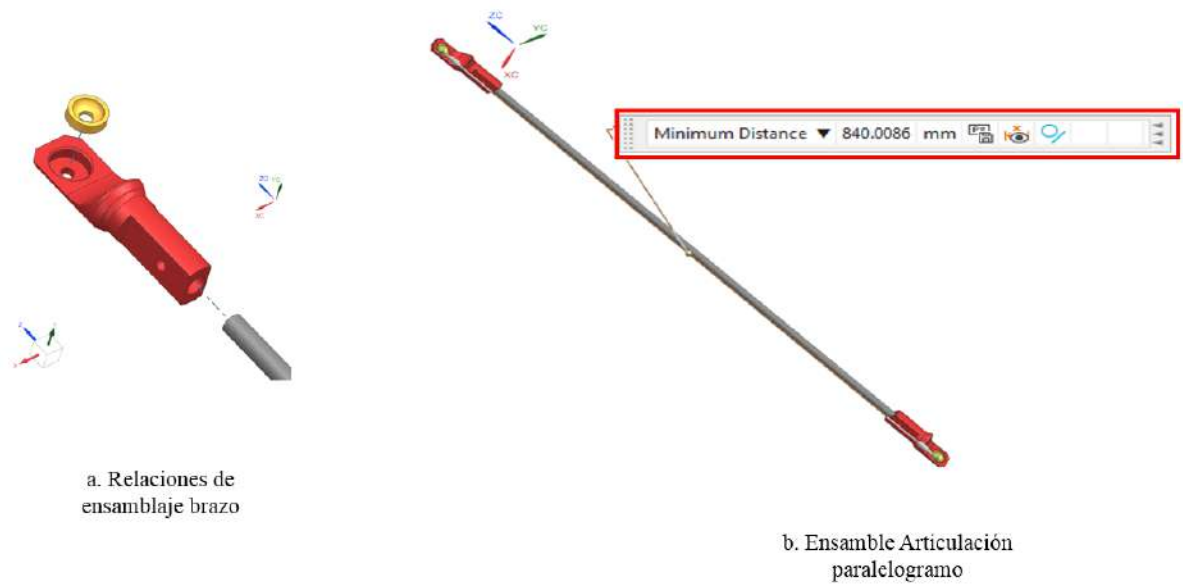
Figura 9. Ensamble y relación de ensamble Articulación paralelogramo Fuente: Autor
