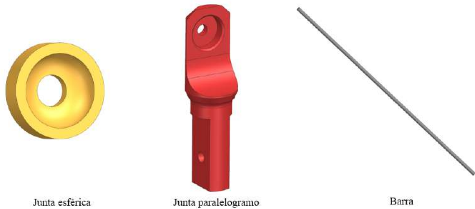
Figura 8. Piezas constitutivas del ensamble Articulación paralelogramo. Fuente: Autor
