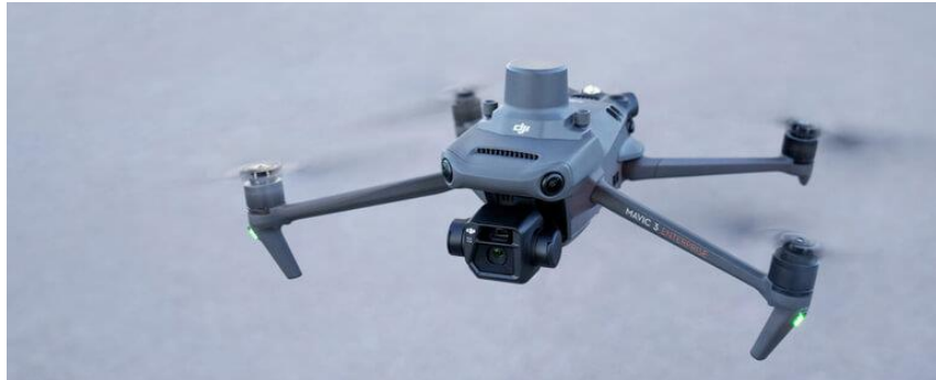
Figura 12. Fotografía de referencia del modelo de dron usado para el levantamiento de información en terreno el MAVIC 3E de la marca DJI
