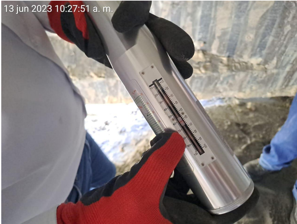
Figura 10. Ensayo de Esclerometría
