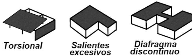
Figura 57: Irregularidades en planta. Fuente: (AIS, 2010).
