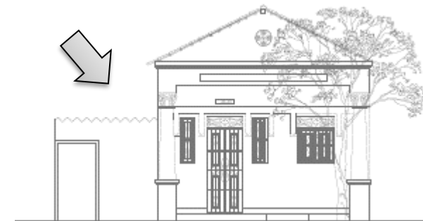
Figura 60: Fachada con irregularidad en altura. Fuente: Elaboración propia.
