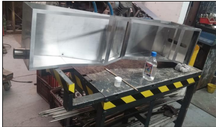
Ilustración 3 Pulido y Acabados de la Canaleta.
