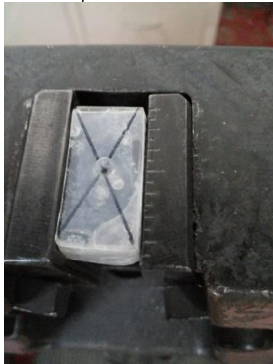
Figura 12. Lámina posicionada en máquina instron
