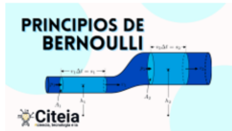
Figura 3. Ley de Bernoulli. Tomado de: https://citeia.com/innovaciones-en-tecnologia/principios-de-bernoulli-ejercicios .
