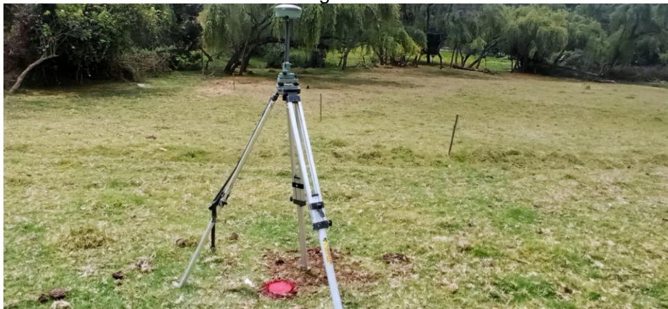
Ilustración 14 - Placa de georreferenciación colocada.
