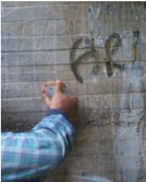
Figura 15. Toma índice de rebote en el concreto
