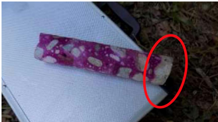
Figura 24. Prueba de carbonatación a concreto del puente
