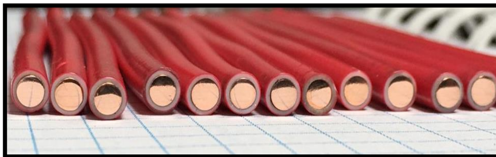
Ilustración 21. Electrodo de cobre de bajo costo
