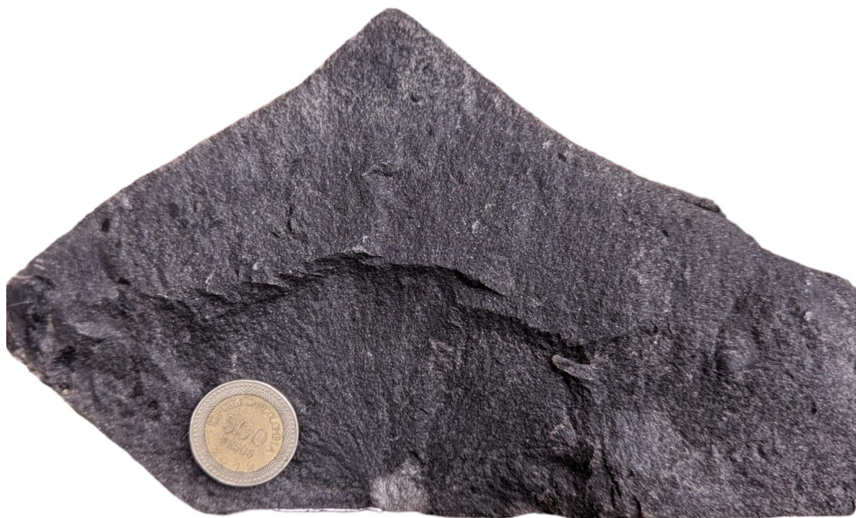
Figura 47. Muestra de mano de Caliza con bivalvos de la Formación Cogollo
