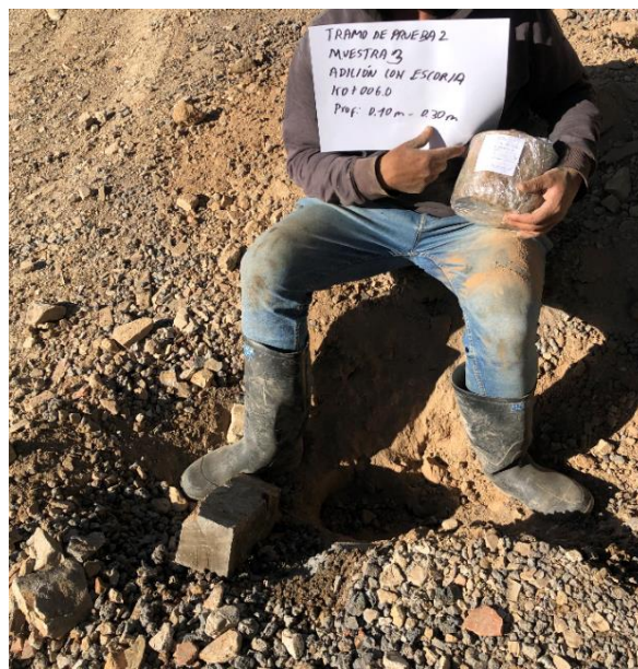
Fotografía 94. Toma de la muestra 3 del suelo alterado con la escoria, en el tramo de prueba 2.
