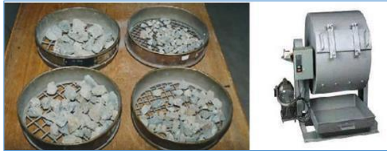
Fotografía 13. Ensayo de desgaste de los agregados. Tamizado y máquina de los Ángeles.
