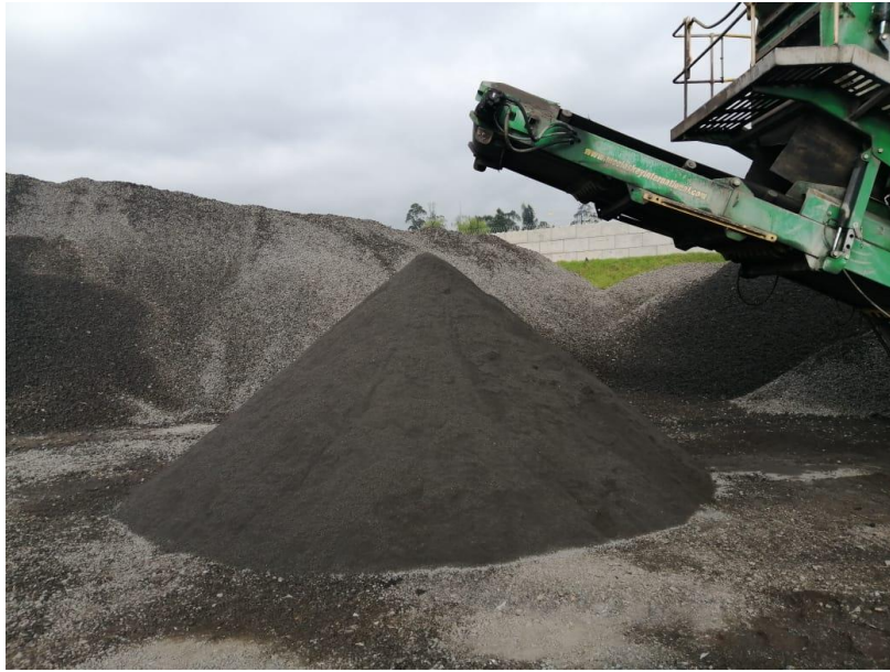
Fotografía 23. Acopio de escoria en el patio de Gerdau Diaco, planta en el Municipio de Tuta (Boyacá).
