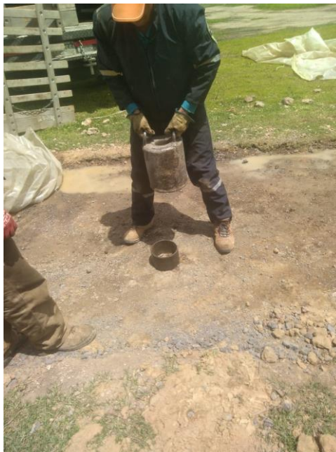
Fotografía 58. Toma de muestras en el terreno con adición de escoria en el tramo de prueba 1.
