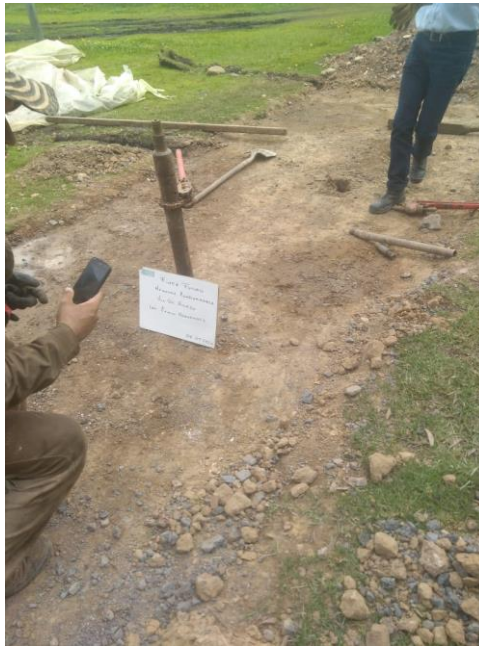
Fotografía 57. Toma de muestras en el terreno con adición de escoria en el tramo de prueba 1.
