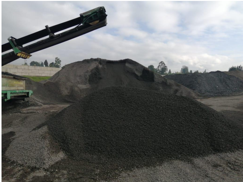
Fotografía 24. Acopio de escoria en el patio de Gerdau Diaco, planta en el Municipio de Tuta (Boyacá).
