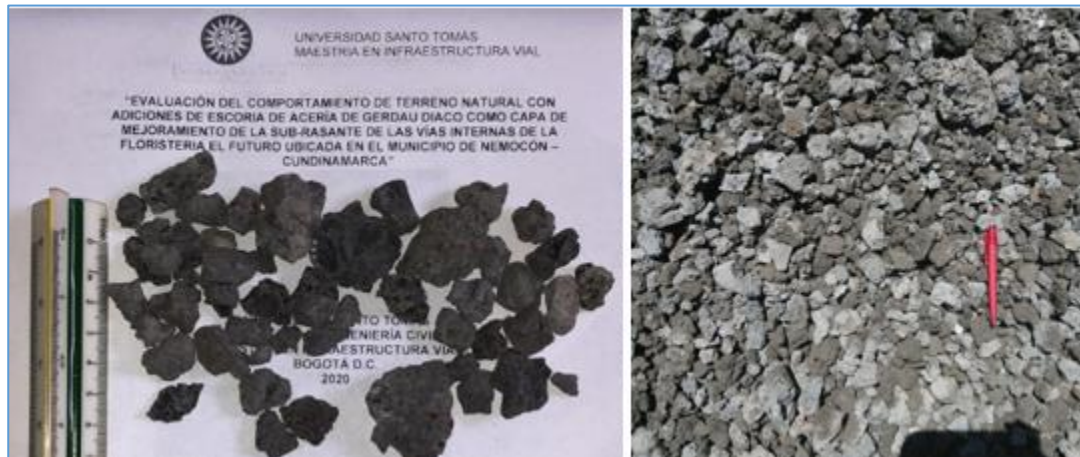
Fotografía 8. Muestra de la escoria obtenida de Gerdau Diaco, planta en el Municipio de Tuta – Boyacá.
