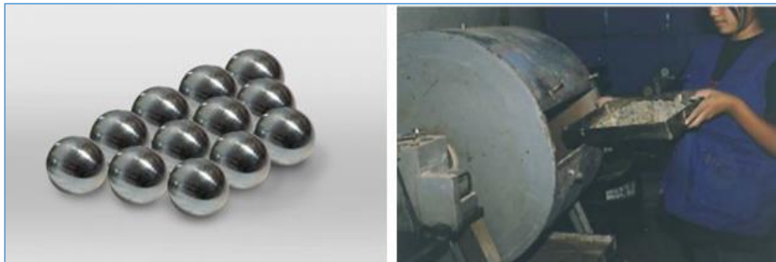
Fotografía 14. Ensayo de desgaste de los agregados. Esferas de acero y máquina de los Ángeles.
