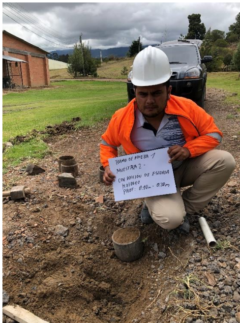
Fotografía 62. Toma de muestras en el terreno con adición de escoria en el tramo de prueba 1, muestra 2.
