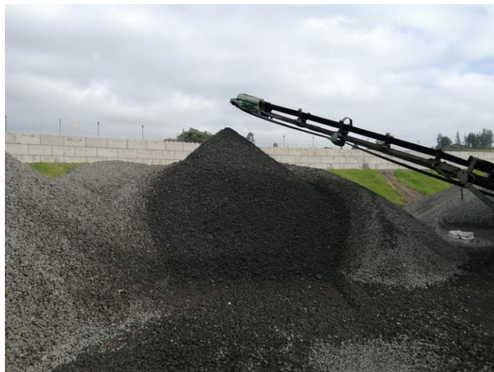
Fotografía 4. Acopio de escoria en el patio de Gerdau Diaco, planta en el Municipio de Tuta (Boyacá).
