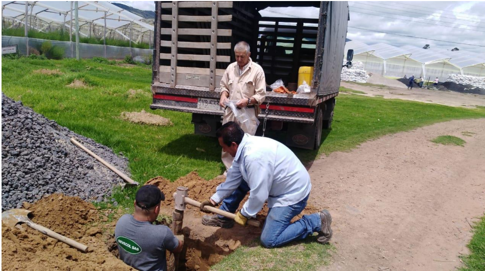
Fotografía 39. Toma de muestras en el tramo de prueba 1, vías de acceso a Flores el Futuro, en el Municipio de Nemocón – Cundinamarca.
