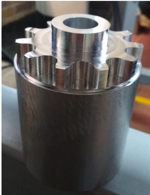
Figura 4-6: Sprocket ANSI 60 de 11 dientes. Fuente: Autor
