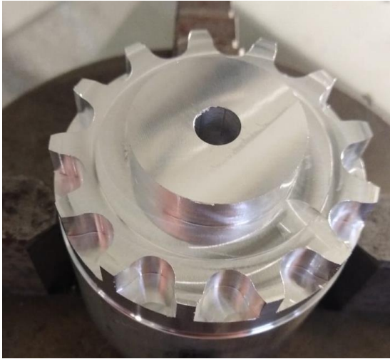
Figura 4 5: Sprocket ANSI 40 de 11 dientes. Fuente: Autor
