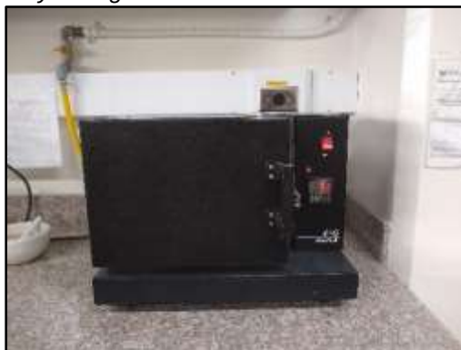
Figura 16. Horno a 375° en ensayo de ignición.
