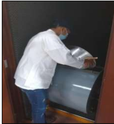
Figura 22. Puesta de la muestra en la máquina de los ángeles.
