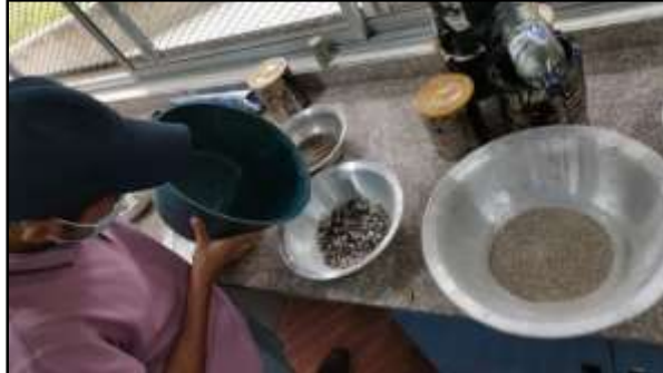
Figura 18. Vertimiento de la solución en cada una de las fracciones de la muestra.
