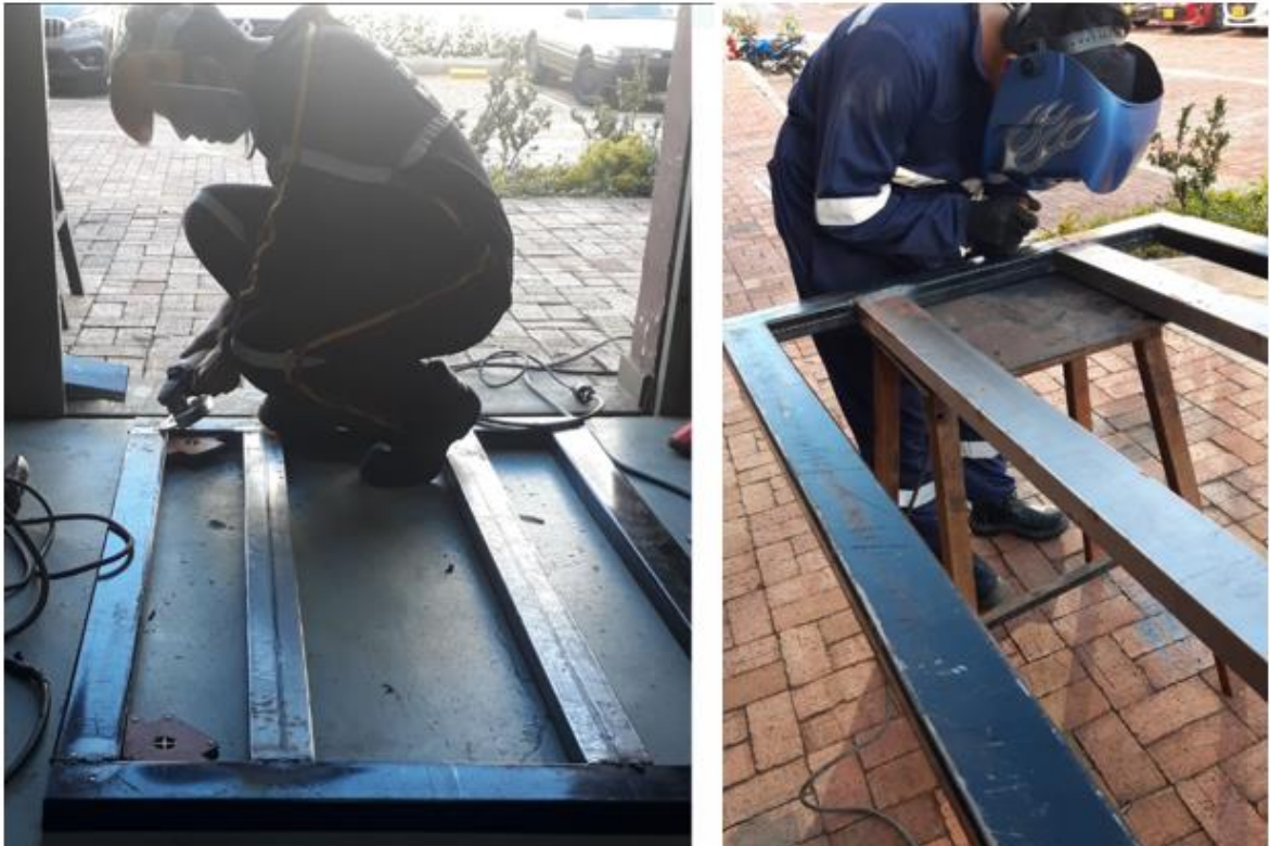
Fig. 30. Estructura de Base Cortadora Láser
