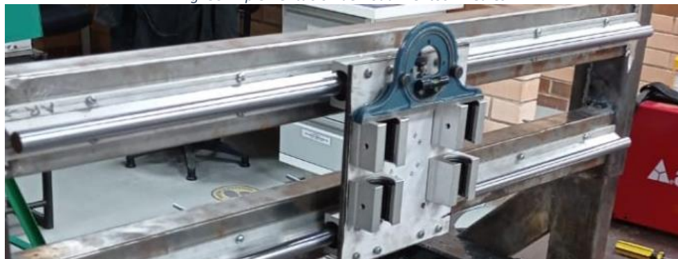
Fig. 35. Implementación de Rodamientos Lineales
