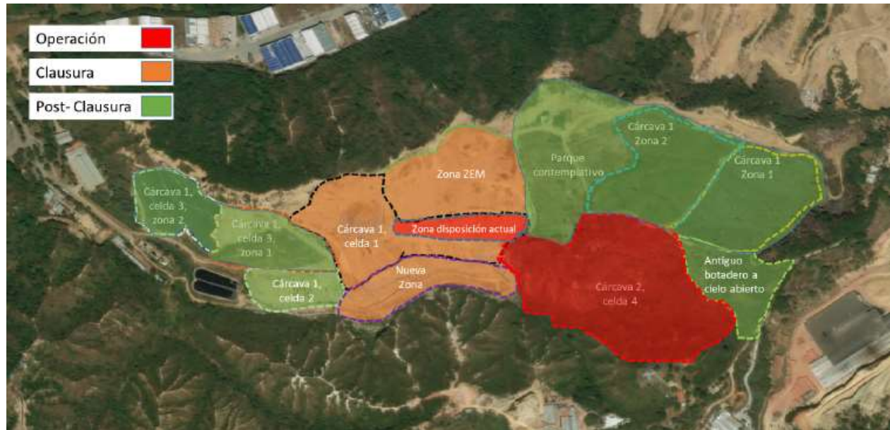
Figura 46. Localización general de las cárcavas y celdas en el relleno sanitario El Carrasco. Fuente: Concepto técnico de inicio de procedimiento sancionatorio ambiental, ANLA, 2017
