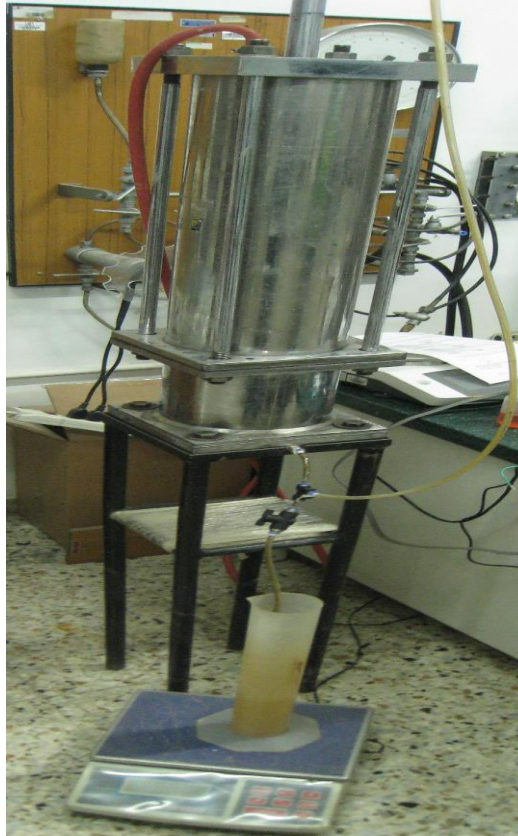
Figura 28. Consolidómetro de lodos, Universidad Nacional de Colombia.
