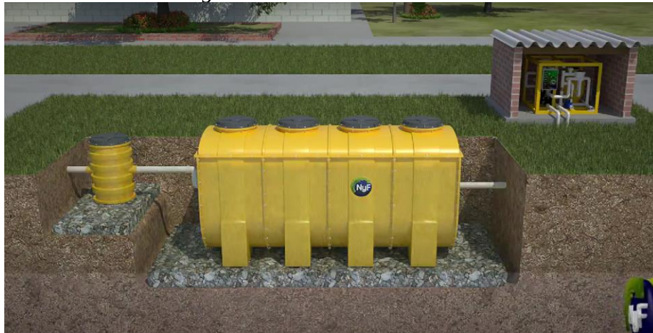
Figura 52. Planta de tratamiento de aguas residuales
