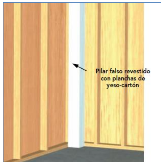
Figura 118. Se reviste la estructura de madera con el mismo material de los muros.
