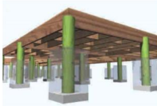
Figura 42. Fundación aislada, pilotes impregnados.
