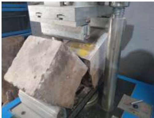
Figura 18. Falla de Vigueta del Diseño de Mezcla 2. (Elaboración propia)
