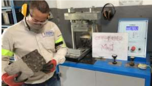
Figura 17. Falla de Vigueta del Diseño de Mezcla 1. (Elaboración propia)
