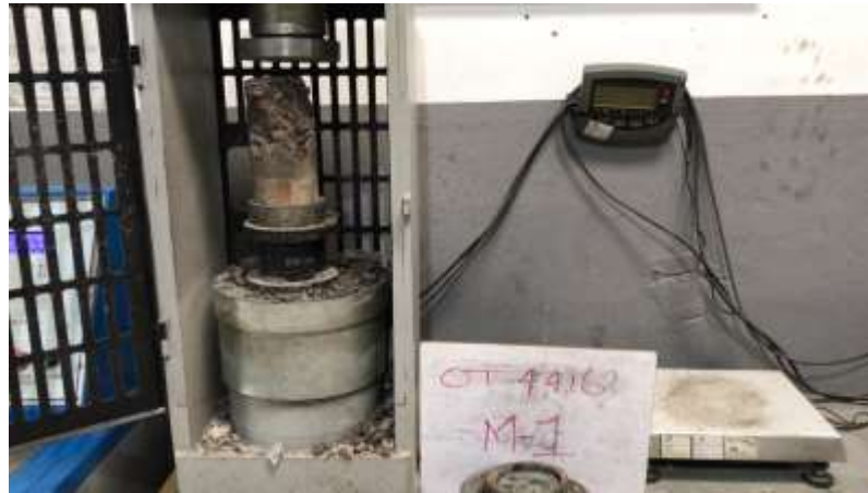
Figura 13. Falla tipo 2 para cilindro del Diseño de Mezcla 1. (Elaboración propia)
