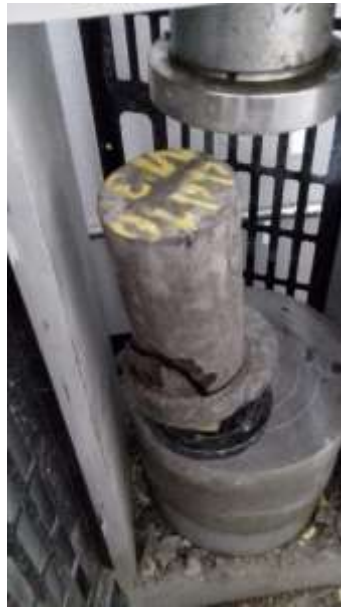
Figura 15. Falla tipo 4 para cilindro del Diseño de Mezcla 3. (Elaboración propia)
