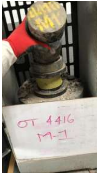
Figura 9. Cilindro Diseño Mezcla 1 sometido a falla. (Elaboración propia)
