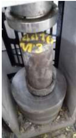
Figura 11. Cilindro Diseño de Mezcla 3 sometido a falla. (Elaboración propia)
