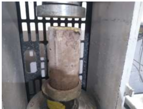
Figura 10. Cilindro Diseño Mezcla 2 sometido a falla. (Elaboración propia)
