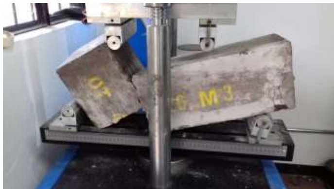
Figura 19. Falla de Vigueta del Diseño de Mezcla 3. (Elaboración propia)
