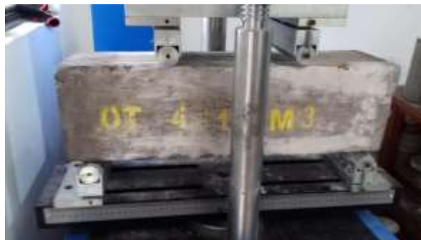
Figura 16. Vigueta del Diseño de Mezcla 3 sometida a flexión. (Elaboración propia)
