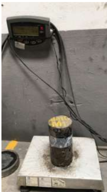
Figura 8. Pesaje Cilindro Diseño de Mezcla 1. (Elaboración propia)
