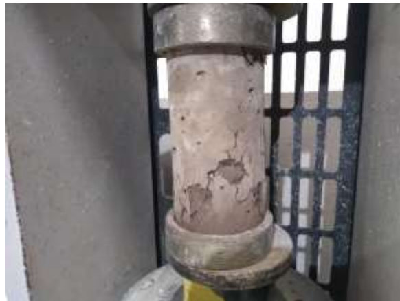
Figura 14. Falla tipo 5 para cilindro del Diseño de Mezcla 2. (Elaboración propia)
