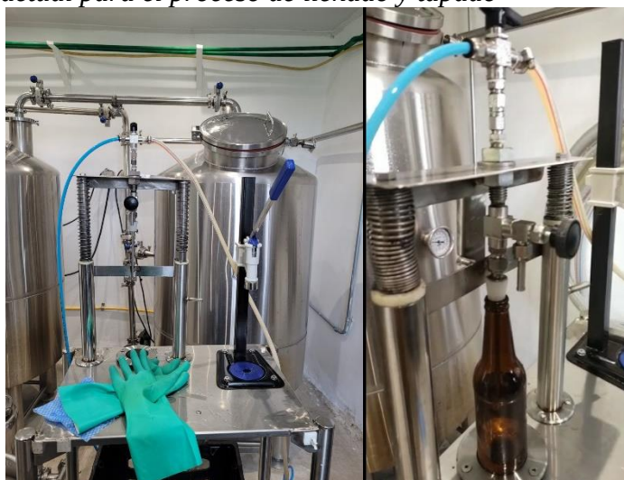
Figura 11. Máquina actual para el proceso de llenado y tapado
