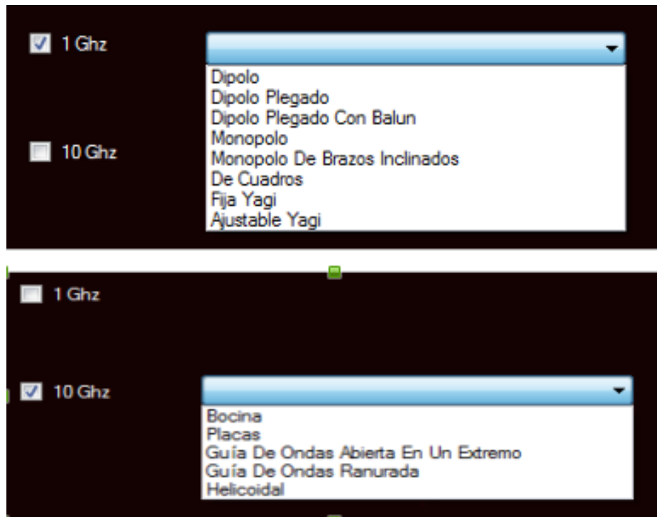
Figura 7: Menú de la ventana de simulation, con menú desplegable para seleccionar el tipo de antena a simular y el tipo de frecuencia en GHz
