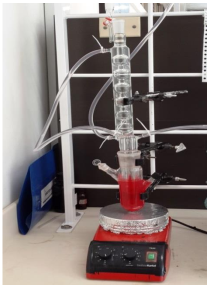
Figura 17. Montaje de degradación del rojo congo
