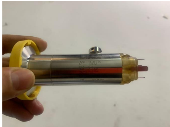
Figura 7. Rango de presión del transmisor (-1 a 1 bar)
