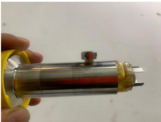
Figura 5. Transmisor de presión utilizado para medir nivel del tanque
