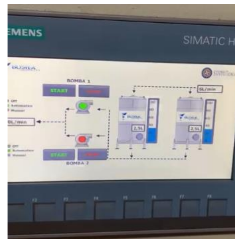
Figura 46. Bomba 2 operando en modo automático caudal de 7L/min
