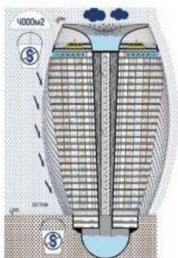
Imagen 1.11 Captación y distribución de la lluvia
