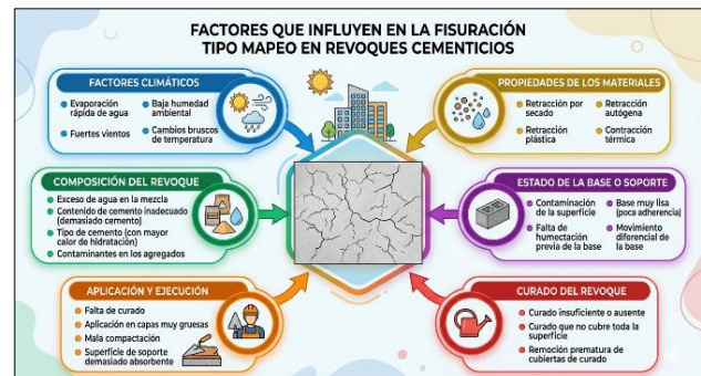
Figura 1. Factores que influyen en la fisuración tipo mapeo en revoques cementicios
