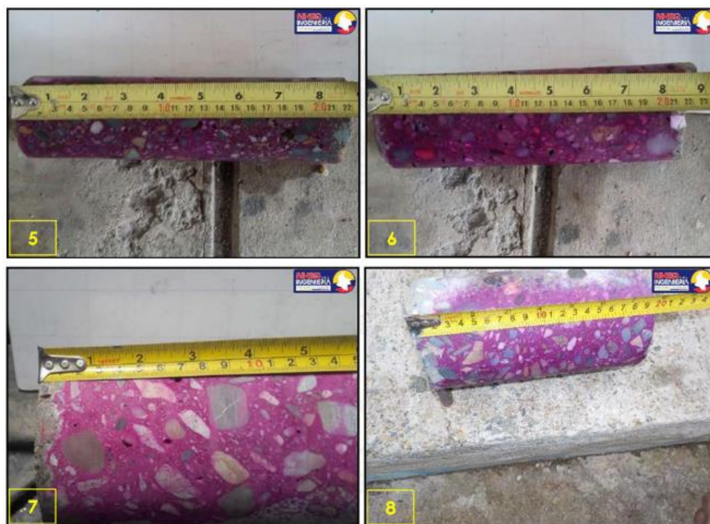
Figura 37. Ensayo de carbonatación a los núcleos de concreto tomados como muestra de los elementos estructurales en estudio del edificio San Silvestre II. Fuente Propia.
