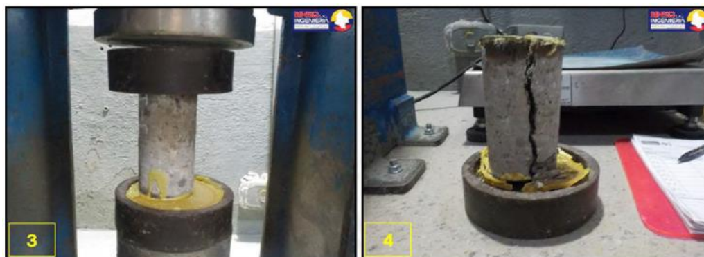
Figura 36. Ensayos de resistencia a la compresión de los núcleos tomados como muestras de los elementos estructurales en estudio del edificio San Silvestre II. Fuente: Propia.
