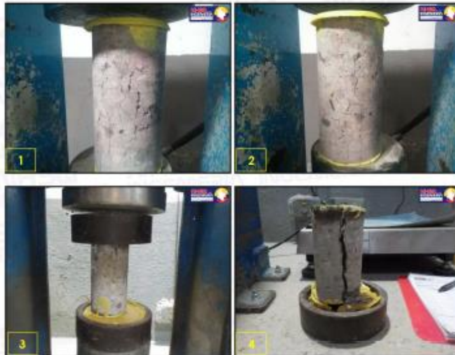
En las imágenes de la 1 a la 4 se muestra la falla de núcleos de concreto.
